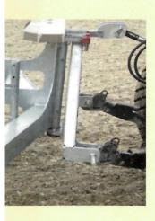
Das Drehgelenk ermöglicht eine optimale Kurvenarbeit. Somit können Hindernisse problemlos umgefahren werden. Die Tretschicht wird nicht mehr in die Ecken verschoben. Die automatische Arretierung fixiert den Steel Master beim Hochheben mit der Traktorhydraulik.
