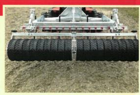
Die profilierte Gummiwalze oder die schuppenförmige Gitternetzwalze glätten und stabilsieren den aufgelockerten Boden.
